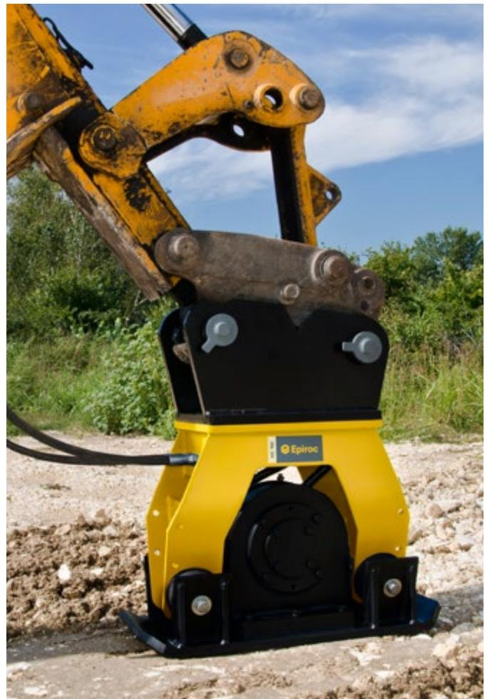
Nos compacteurs hydrauliques silencieux permettent de travailler rapidement, sont faciles à utiliser et facilitent le positionnement.
