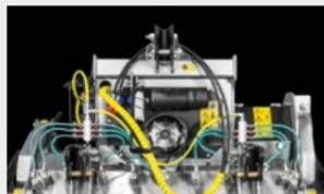
**Le système Water Spray System** sert à refroidir les outils pour leur donner une plus grande résistance
