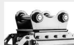
**Plaque d'attache avec axes**
