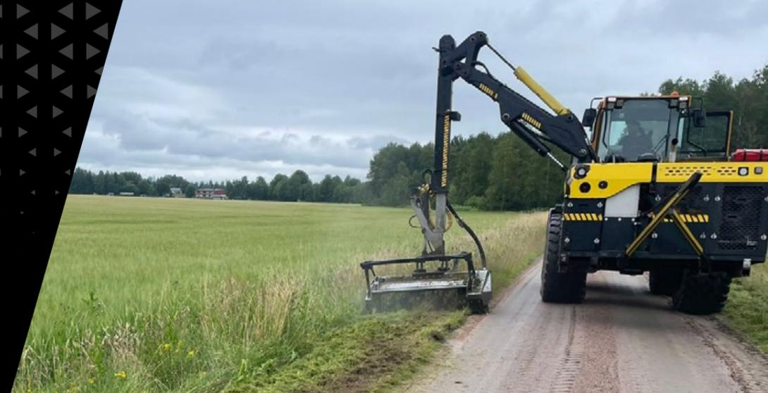
**Capot arrière hydraulique** permet d'obtenir un broyage optimal et de réduire la projection du matériau broyé
