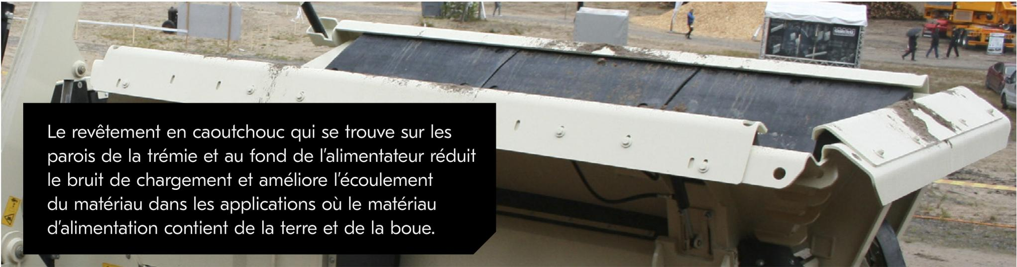
Le revêtement en caoutchouc qui se trouve sur les parois de la trémie et au fond de l'alimentateur réduit le bruit de chargement et améliore l'écoulement du matériau dans les applications où le matériau d'alimentation contient de la terre et de la boue.
